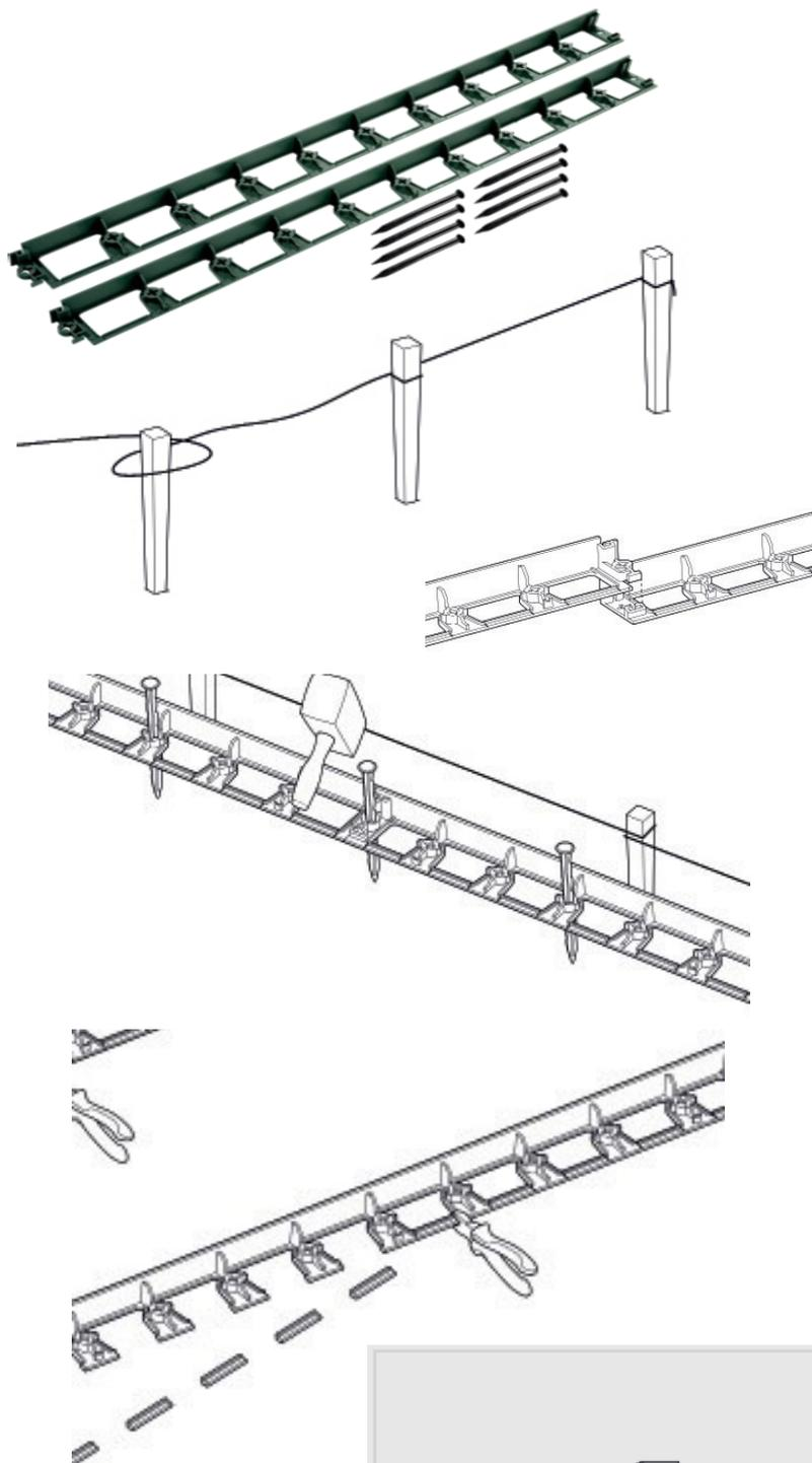
Zur perfekten Positionierung empfehlen wir eine Richtschnur (Mauerschnur) mit Holzpflocken sowie einer Wasserwaage zu verwenden. Bei geraden Kanten ist auch eine Richtlatte aus Alu oder ein gerades Brett geeignet.
